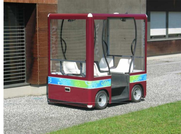
En 2002, le laboratoire a pris la décision d'orienter son domaine applicatif de recherche vers le véhicule autonome électrique afin d'avoir des démonstrations réelles sur les thèmes suivants : vision par ordinateur, fusion multi sensorielle, commande.
